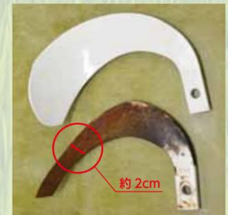
爪の先端が摩耗して幅が2cmくらいになると交換の時期です。
