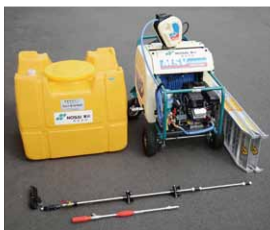
動噴、ローリータンク、かくはん機、ノズル2本、アルミブリッジ
