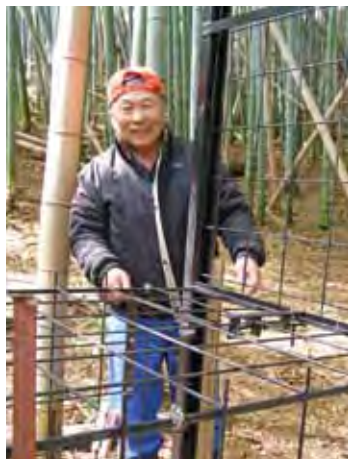
ワイヤーメッシュ 5 枚とワイヤークリップ 32 個で製作した箱わな
