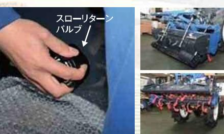
耕うん爪の泥や異物除去など、作業機を上げて作業する際、手元のレバーだけで固定するのではなく、必ずスローリターンバルブで固定してください。レバーだけの場合、何かのはずみで動けば、上げていた作業機は一気に落ちます。
